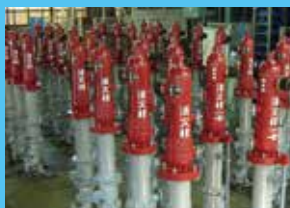
地上式消火栓
